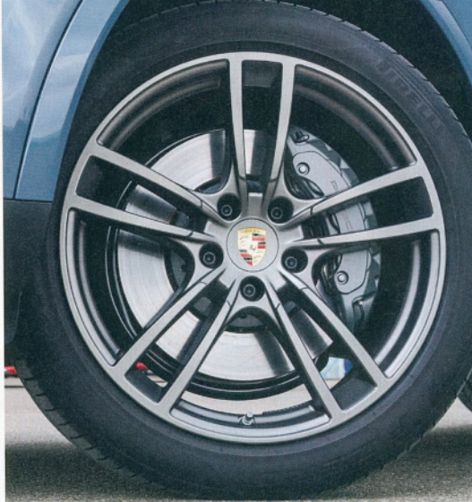
Trotz Serienbremse stoppt der neue Cayenne S auf dem Niveau der alten Turbo-Cayenne. Voraussetzung: die Investition in mischbereifte 21-Zöller
