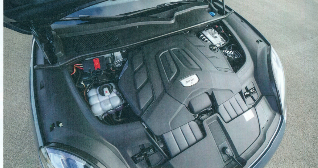
Wo Porsche es bei 440 PS und 550 Nm bewenden lässt, traut HGP dem V6 555 PS und 790 Nm zu. Klingt nach Himmelfahrtskommando für die beiden Serienlader, fuhr sich im Test aber stets harmonisch, unaufgeregt und allzeit leistungskonstant. Step 2 mit größeren Ladern bringt 615 PS und 819 Nm
