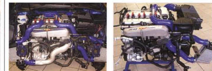
■ Unterschiedliche Schale, fast gleicher Kern: Als Tuning-Basis dient das V6-Aggregat aus dem VW-Konzern. Serienmäßig leistet der 3,2-Liter-Motor 250 PS. Durch die Verpflanzung eines Turboladers samt Ladeluftkühler bringt es die Zender-Maschine auf 440 PS (rechtes Bild). HGP setzt noch einen drauf. Ebenfalls durch einen Turbo zwangsbeatmet, aber gleich mit zwei Kühlern zur Regelung der Ladeluft versehen, liegt die Leistung des Golf bei imposanten 495 PS.
