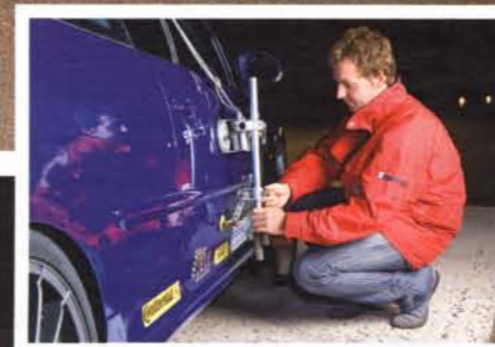
Nacht: SPORTSCARS-Testfahrer Sebastian Schneider montiert den Corrsys-Datron-Messarm am Golf. Parallel installieren wir ein GPS-Gerät
