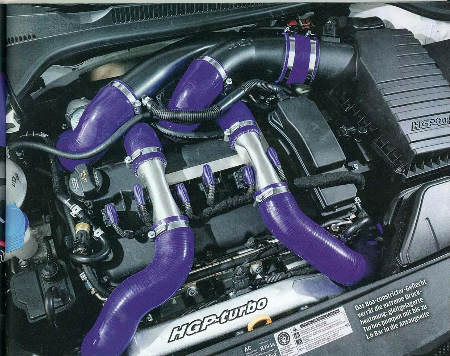
Das Boa-constrictor-Geflecht verrottet die extreme Druckbelastung; gleitgelagerte Turbos pumpen mit bis zu 1,6 Bar in die Ansaugseite
