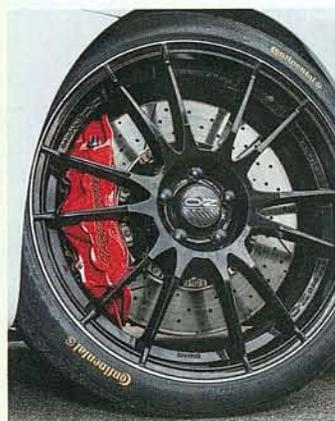
HGP nutzt eine modifizierte AMG-Bremse mit 390-mm-Scheiben vorn
