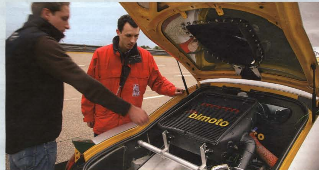
... und hinten noch mal so viele. Der riesige Ladeluftkühler stellt sich der thermischen Herausforderung
