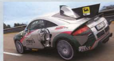
Flossen hoch: Der martialische Aufbau fächert dem Motor Luft zu
